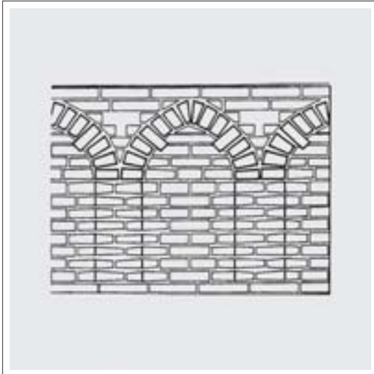
شکل ۶: جزئیات آجرکاری قسمتی از قطاربندی
