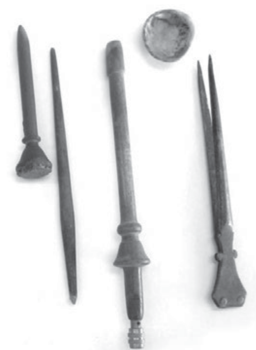
تصویر ۹- قبضه، قلم تحریر، ظرف کوچک آب دست و انبر مخصوص نگین، از لوازم جانبی دستگاه عقیق‌کن، قدمت قاجاریه و پهلوی، مجموعه خاندان حمیدی حکاک شیرازی، ماخذ: نگارندگان
