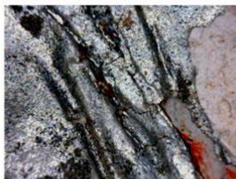
تصویر ۱۵- چین خوردگی ورق فلزی استفاده شده روی آرایه گچی قالبی، تصویر از پشت ورق با بزرگ نمایی ۶۵ برابر
