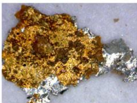
تصویر ۱۶- لایه براق روی آرایه گچی قالبی و ورنی زرد رنگ استفاده شده روی آن، بزرگ نمایی ۶۵ برابر
