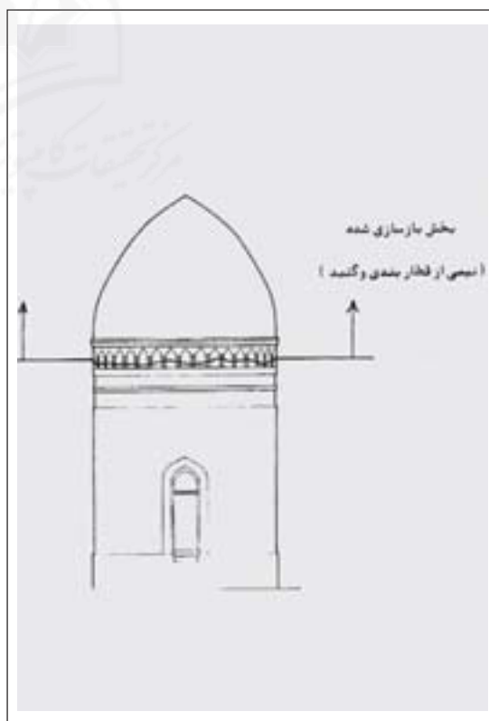
شکل ۵: قسمت بازسازی شده برج لاجیم در چند سال گذشته که شامل گنبد و نیمی از قطاربندی می شود.
